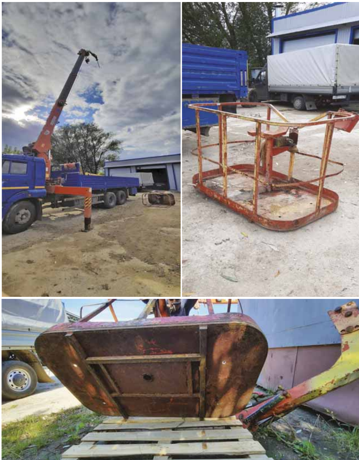
Рис. 50. Результат падения люльки автомобильного крана-манипулятора АСКМ-М R0092X2 в ООО НПФ «Прометей» (г. Калуга)
