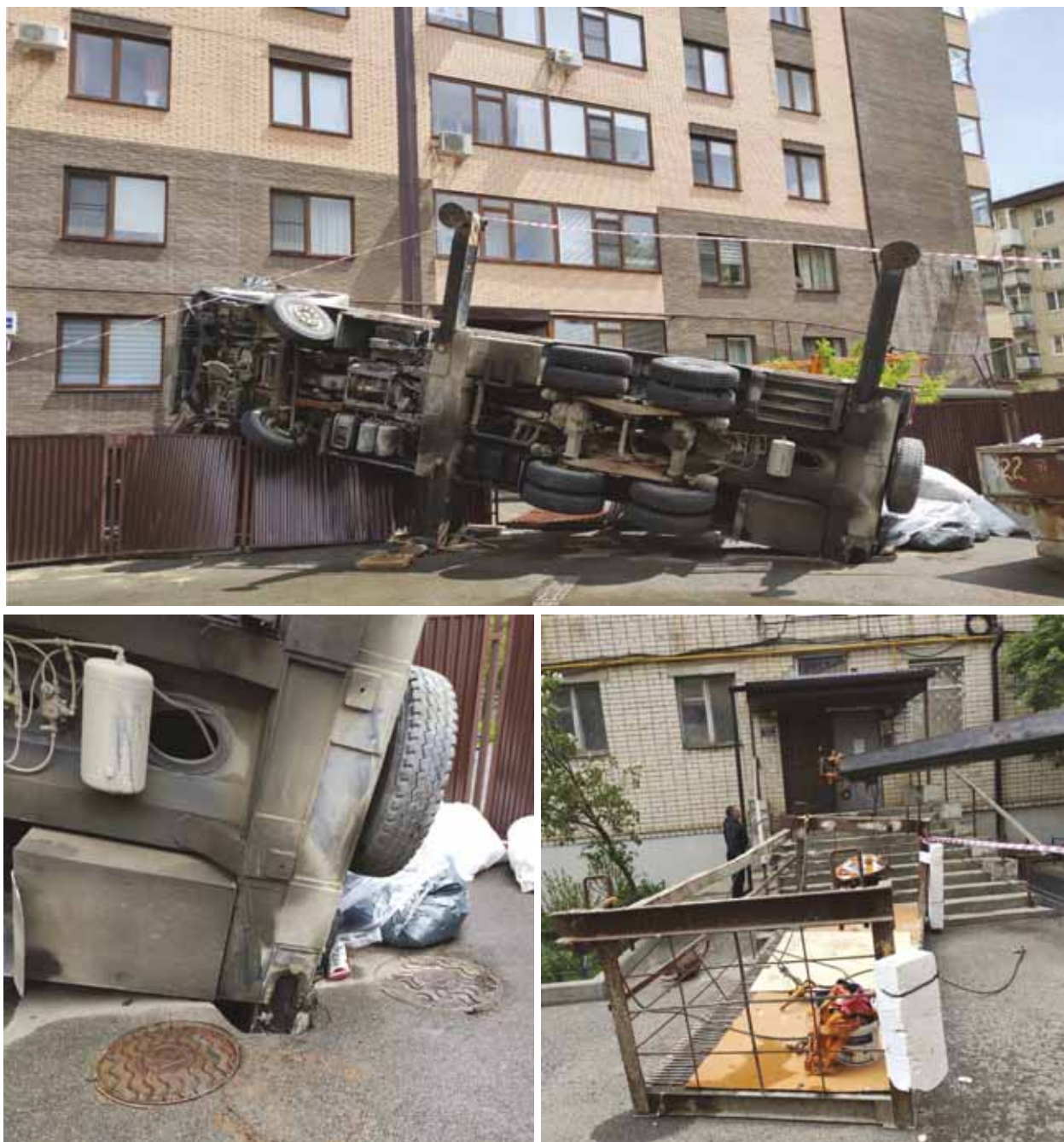
Рис. 47. Опрокидывание автокрана в ООО Фирма «Югкомстрой» (г. Ставрополь)
